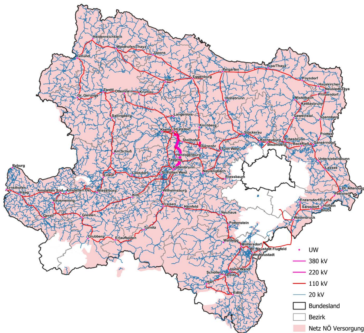
Abbildung 2: Kartendarstellung des Stromnetzes der Netz Niederösterreich GmbH (Netzebenen 1 bis 5 sowie Umspannwerke)
